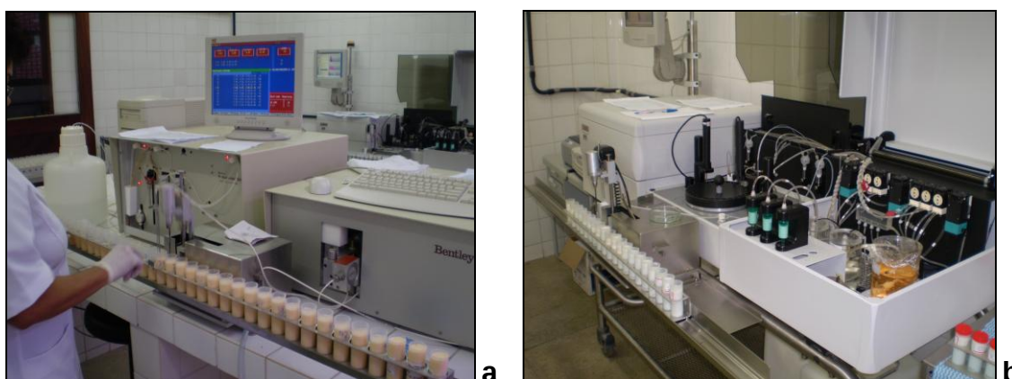
Figura 9. (a) Equipamento eletrônico para análise da composição e CCS das amostras de leite cru refrigerado
